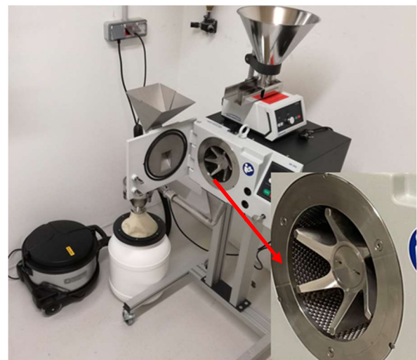
Figure 1 : Broyeur à couteaux Retsch SR300 et chambre de broyage du broyeur
